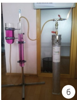
3-р зураг. Чөмгөн (кернийн) дээжинд хий хэмжих багажны ажиллагаа: а. Хий хэмжих багаж, б. Хий хэмжээний дараа хийг агаарт гарган шатааж аюулгүй болгодог. в. Хийг нь хэмжих дээжийн температурыг тогтмол байлгахын тул бортоготой дээжийг усан ваннд тогтмол температурт байлгана.
