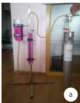
3-р зураг. Чөмгөн (кернийн) дээжинд хий хэмжих багажны ажиллагаа: а. Хий хэмжих багаж, б. Хий хэмжээний дараа хийг агаарт гарган шатааж аюулгүй болгодог. в. Хийг нь хэмжих дээжийн температурыг тогтмол байлгахын тул бортоготой дээжийг усан ваннд тогтмол температурт байлгана.
